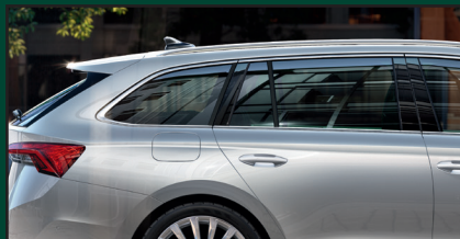
Sunset – przyciemniane tylne szyby boczne i szyba pokrywy bagażnika
